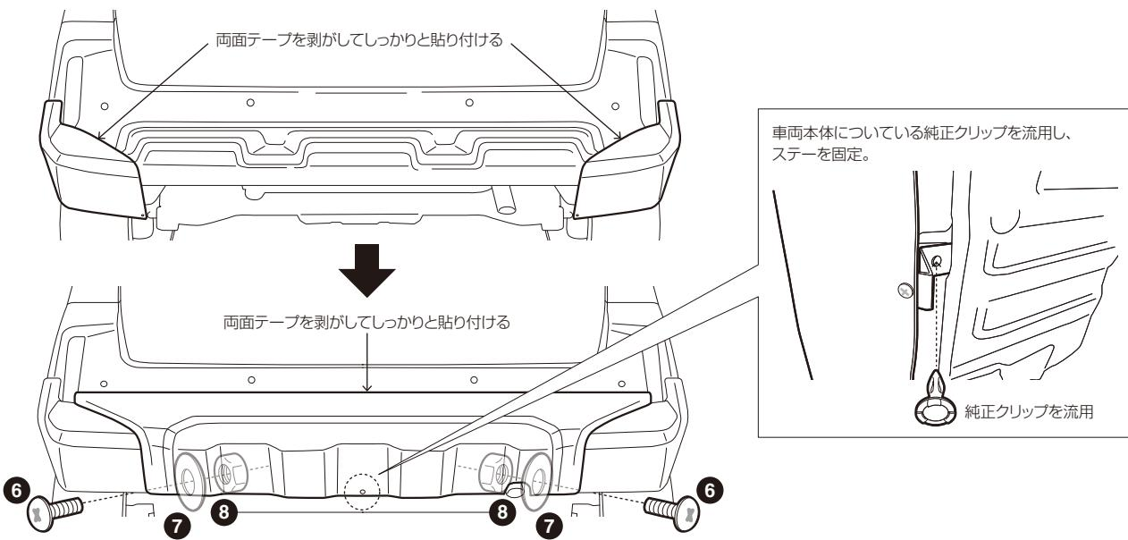
M4ボルト・ナット・ワッシャーを使用し、サイドとセンターの重なる2カ所を固定
