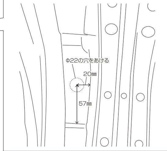
空けた穴を利用して、付属のM5トラスボルト・ナットを使用し、KUHLルーフエンドウイングをしっかりと固定してください。
