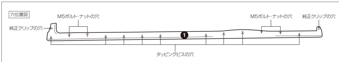
KUHLサイドディフューザーの仮合わせを行います。純正クリップを流用して仮固定を行い、付属のM5ボルト・ナットで固定する穴位置を利用し、純正サイドステップ側にM5用の穴を2カ所あけてください。穴あけ後、M5ボルト・ナットで固定し、最後に付属のM5タッピングビスで10カ所を固定してください。
