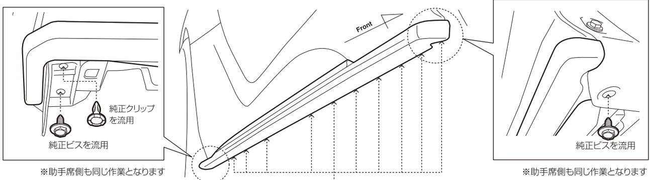
ペン等を使用し、ボディ側11カ所(ウェルナット用8カ所、M5ボルト用3カ所)に印をつけてください。
