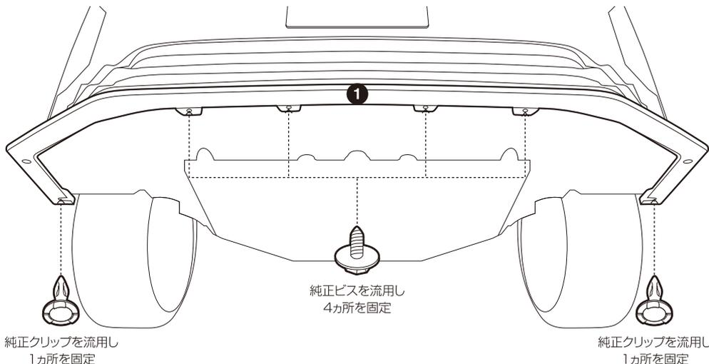
次に、付属のM5ボルト・ナットを使用し、5カ所を固定します。ドリル等を使用し、5カ所の穴位置からボディ側にM5ボルト用の穴を開けて取り付けてください。
