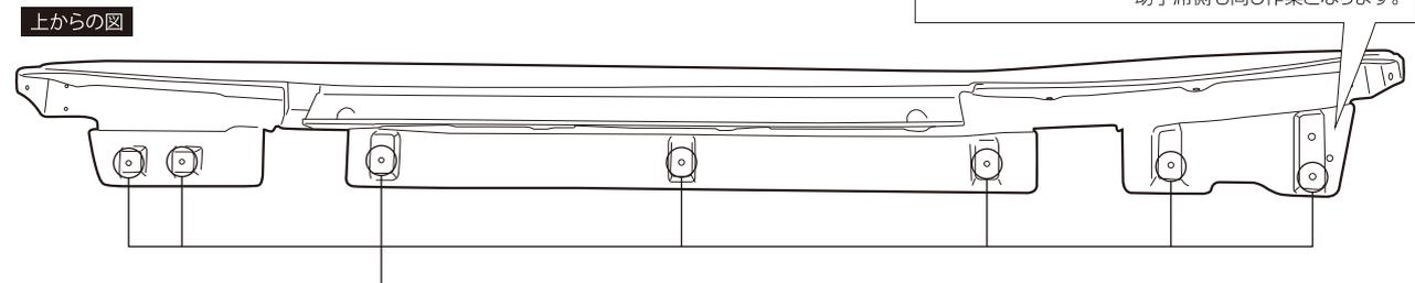
※図の○印部分は取り付け作業の際に外側より純正ビスを7カ所固定する穴となりますので参考になしてください。
