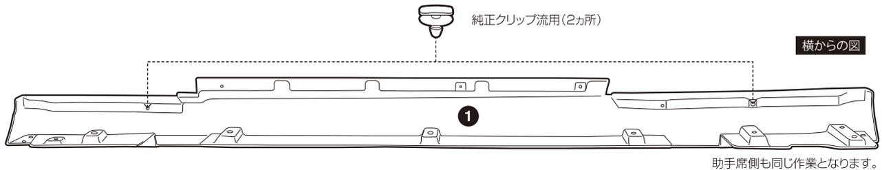
次に、取り外した樹脂パーツを純正クリップを流用しKUHLサイドステップに取付けてください。
