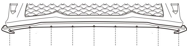
次に、下の9ヵ所の穴位置を利用し、ペン等を使用して純正バンパー側に穴あけ用の印をつけてください。
