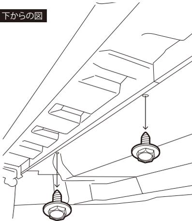
② 付属のステーを取り外した純正ビス・付属のM6×10ボルトを使用して固定してください。
