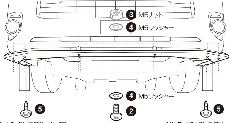
付属のM5ボルト・ナット・ワッシャーとM5タッピングビスを使用し、KUHLフロントディフューザーの取り付け作業を行ってください。
