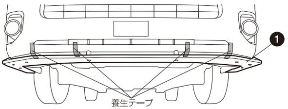
次に下面の8カ所の穴位置を利用し、ペン等を使用して純正バンパー側に穴あけ用の印をつけてください。
