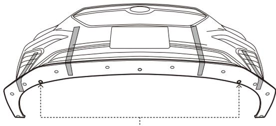
次に、下面の2カ所の穴位置を利用し、ペン等を使用して純正バンパー側に穴あけ用の印をつけてください。
