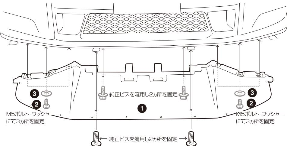
次にフロントハーフスปイラー部の取り付けを行います。フロアパネルと合わせて純正クリップ・ビス・キャップを使用し取り付け作業を行ってください。
