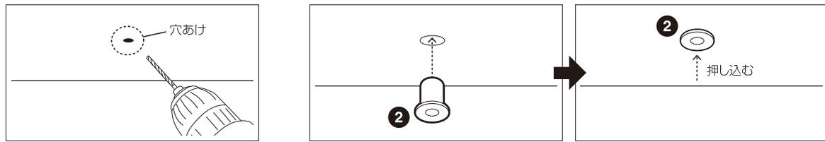
ドリル等を使用し、9カ所の印位置に9mmの穴を開けてください。 次に付属のウェルナットを穴にセットします。(9カ所)
