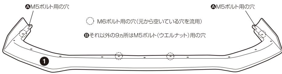
\*穴あけ後右図を参考に、9カ所に付属のウエルナットの取付け作業を行ってください。
