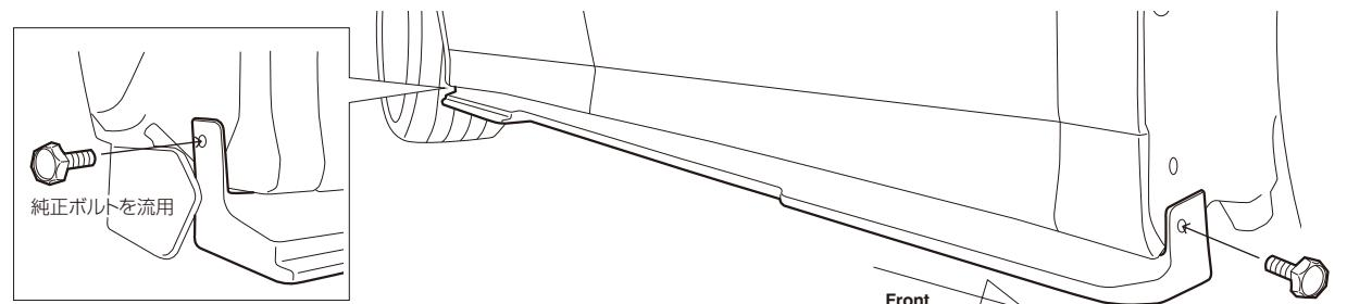
次にサイドディフューザーの固定位置を決め、元から空いている5カ所の穴位置よりベン等でボディ側に印をつけて、ボディ側にM4タッピングを固定する穴あけ作業を行ってください。穴あけ後、付属のM4タッピングビスを使用し、5カ所を固定してください。
