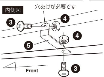
最後に、サイドディフューザーの内側部を付属のM5ボルト・ナット・ステーを使用し、2カ所固定作業を行います。ステーの固定位置はサイドディフューザー下面にステーの固定用の穴がございます。
