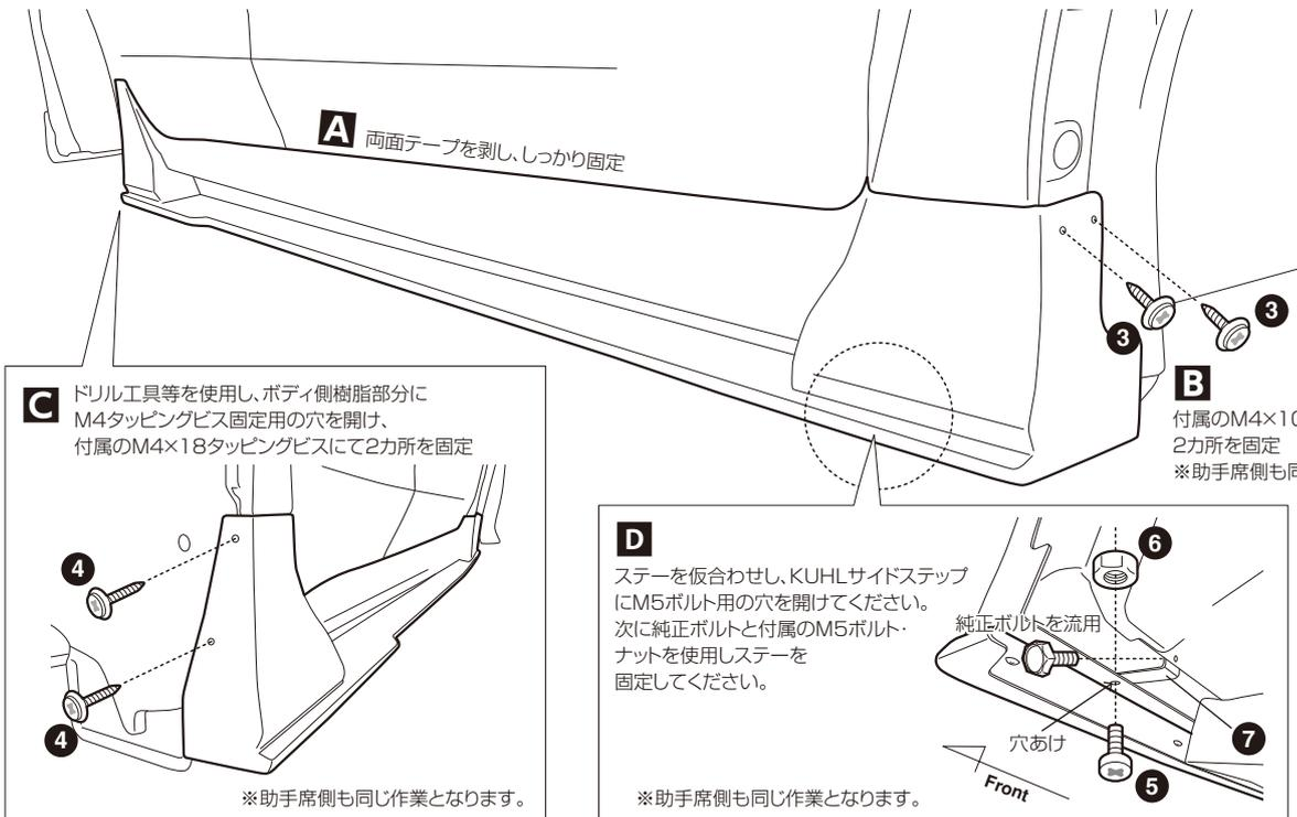
**C** ドリル工具等を使用し、ボディ側樹脂部分にM4タッピングビス固定用の穴を開け、付属のM4×18タッピングビスにて2カ所を固定
