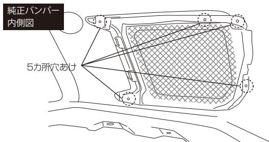
次に付属のM4タッピングビスにてフロントバンパーディフューザーの固定作業を行います。
