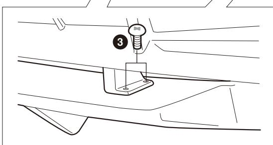
次にステー部をM5トラスボルトで固定します。
