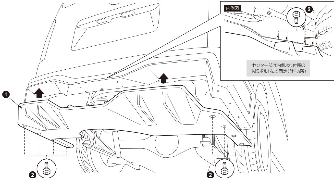
リアフローティングディフューザー左右部は付属のM5ボルトにて外側より固定(左右計8カ所)
