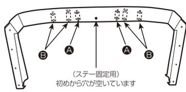
**A** 専用リアディフューザー(マフラーレスタイプ) 4カ所を固定するための穴をリアバンパーに空ける。
